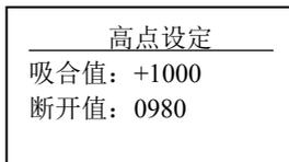
在 pH 模式下，高点继电器一般用于加酸计量泵控制。
