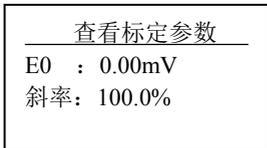
此界面仅供查看, 标定后电极的零电位 E0 和斜率。
